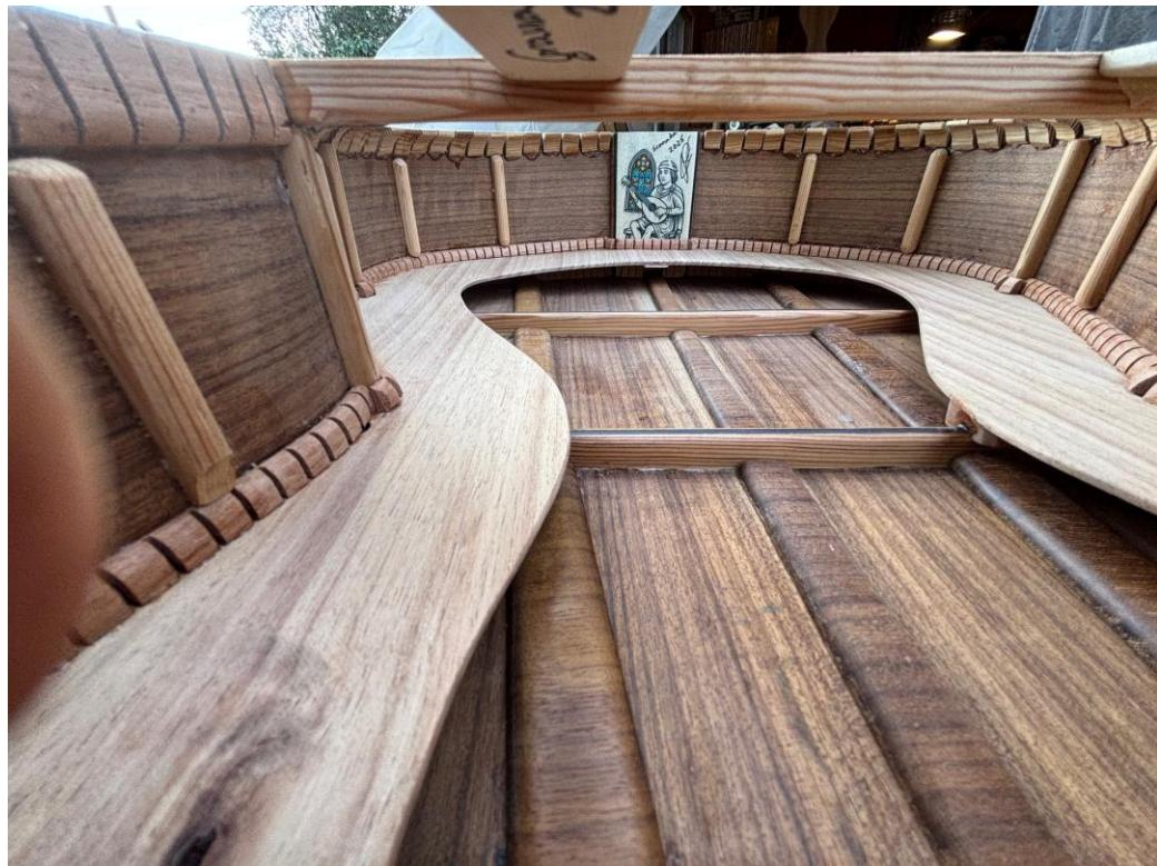
El principio consiste en disponer dos fondos paralelos separados por una cámara de aire de aproximadamente 15 mm, espacio necesario para salvar las barras transversales y permitir el comportamiento acústico independiente de ambas láminas.
