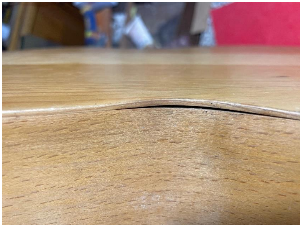
Fondo despegado del costado en cintura derecha, donde se aprecia la madera de haya.
