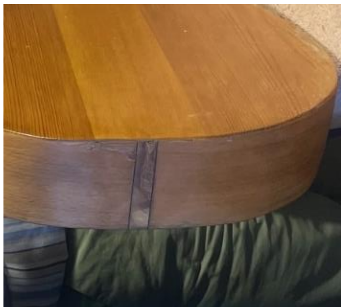
3.3.11 Colocación de unión de costados en madera de olivo.
